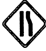
3c Penyempitan di kanan jalan
