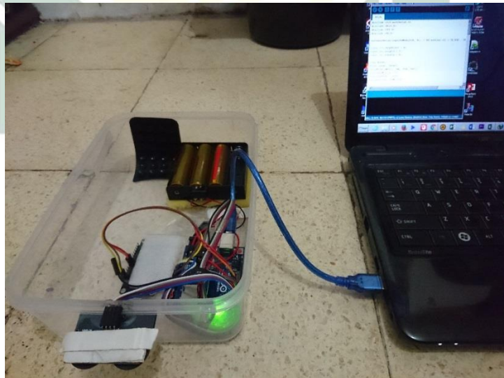
Gambar 4.15 Proses Mengunggah program ke Arduino Uno
