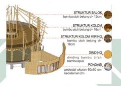
Gambar 4.11 Rancangan Struktur Pondasi
