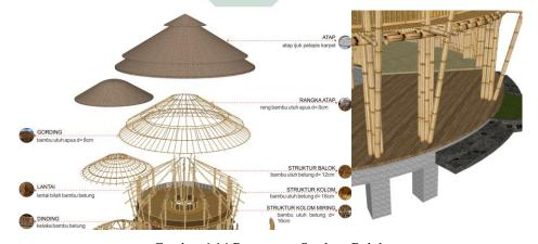
Gambar 4.14 Rancangan Struktur Balok
