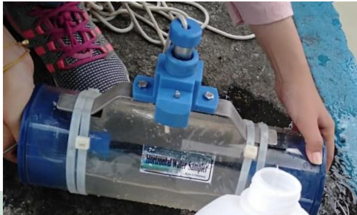
Gambar 3.4 Contoh alat pengambilan contoh air ponit sampler tipe horisontal
