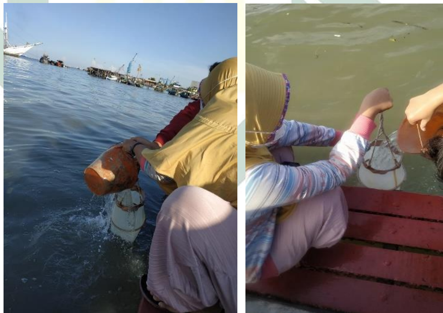
Gambar 3. 2 Pengambilan Sampel Air Laut
