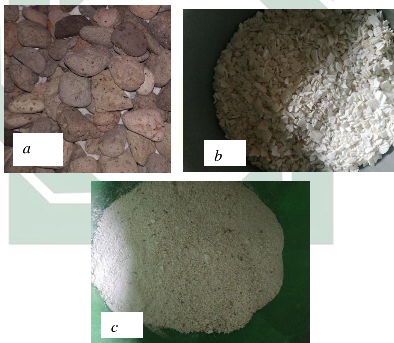
Gambar 4. 5 Komponen Filter Media Cangkang Kerang ( a ) kerikil ( b ) cangkang kerang ukuran 3 mesh ( c ) cangkang kerang ukuran 30 mesh
