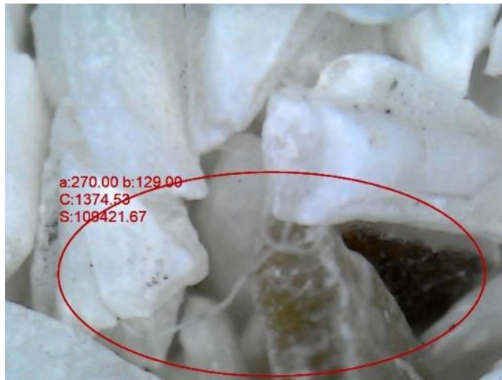
Gambar 4. 7 Mikroplastik Tertahan di Media Filter media cangkang kerang
