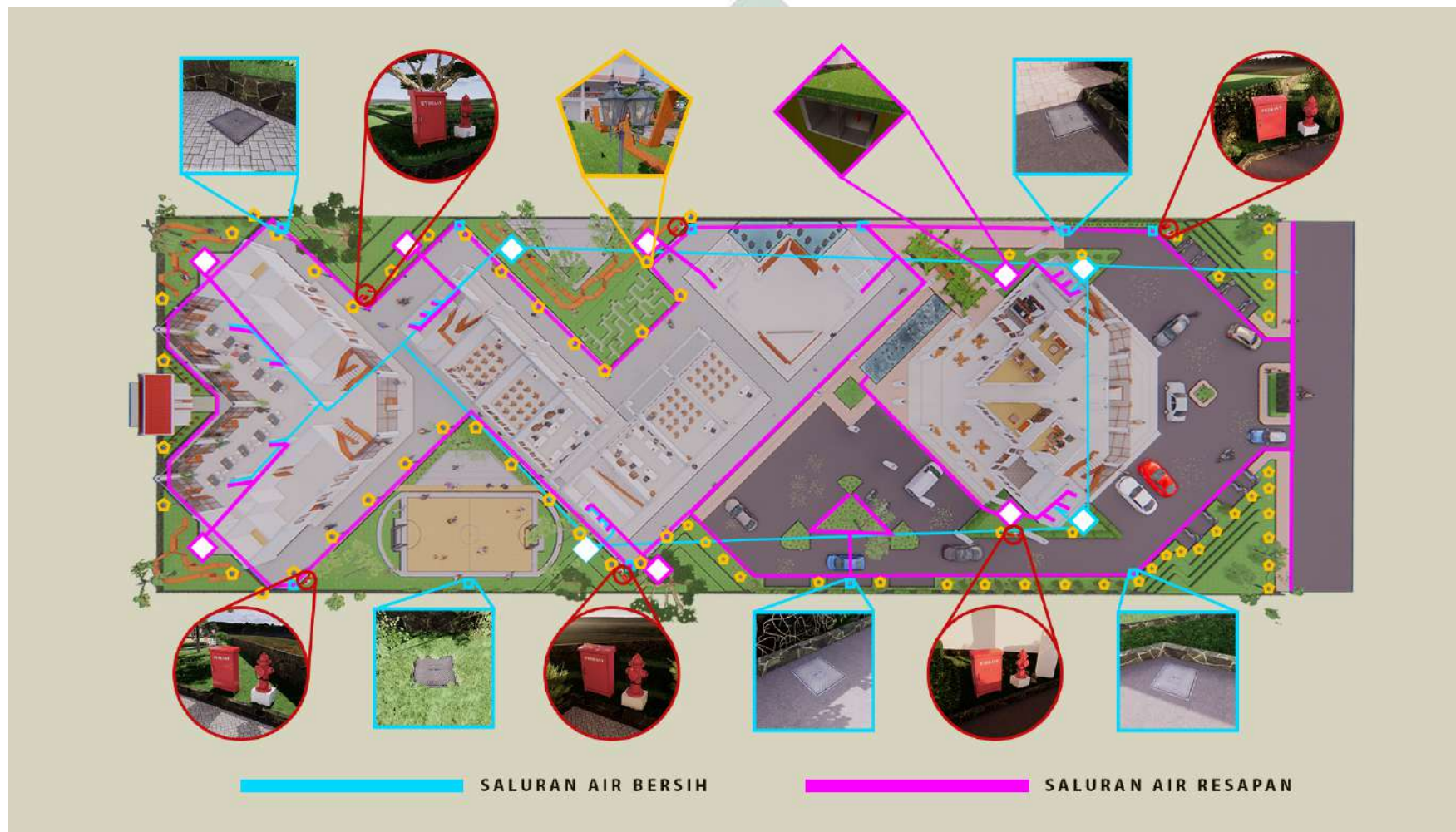
Gambar 4. 33 Sistem Utilitas Air Bersih, Air Kotor, Kebakaran dan Pencahayaan Bangunan As-Sunnah Center Surabaya
