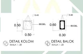
Gambar 4.9 Detail Struktur Kolom & Balok
