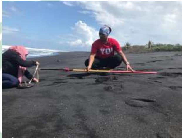
Gambar 4.1-6 Pengukuran Kemiringan Pantai Watu Pecak (Sumber : Dokumentasi peneliti, 2020)
