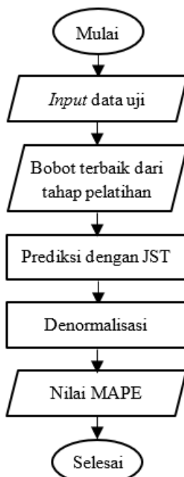
Gambar 3.3 Diagram alir tahap pengujian metode PSO-JST
