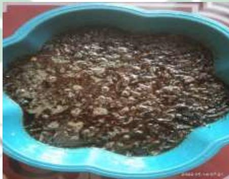
Gambar 4. 4 Proses Aktivasi Kulit Pisang Kepok dengan Larutan NaOH
