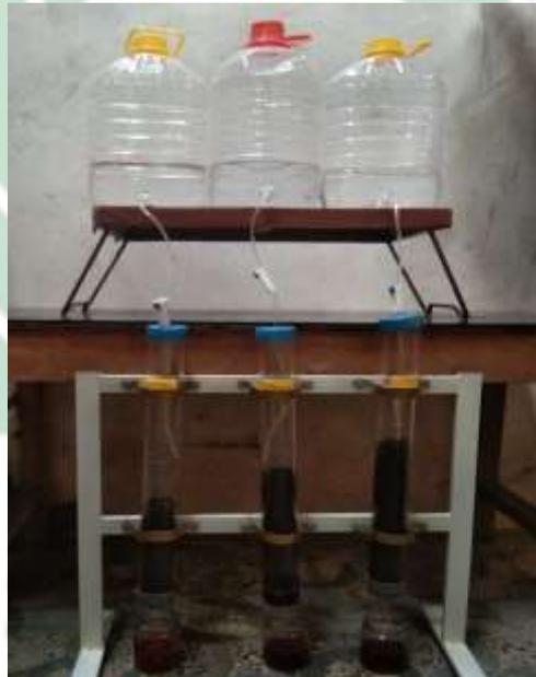
Gambar 4. 5 Percobaan Reaktor dengan Sistem Kontinyu
