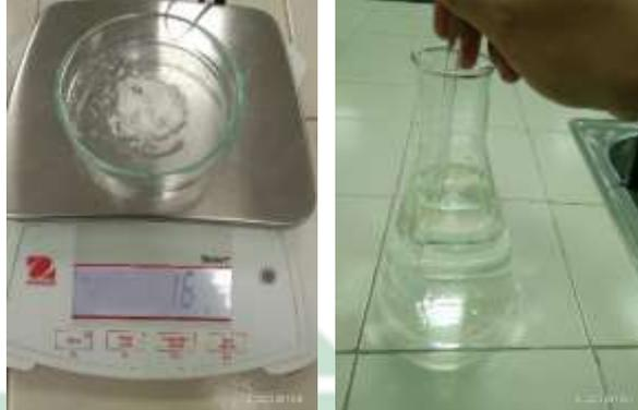
Gambar 4. 6 Penimbangan Serbuk  $Pb(NO_3)_2$  dan Proses Pelarutan
