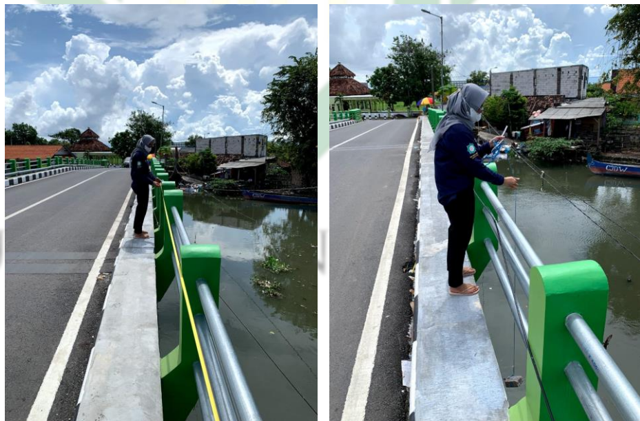
(a) Pengukuran lebar sungai (b) Pengukuran kedalaman sungai
