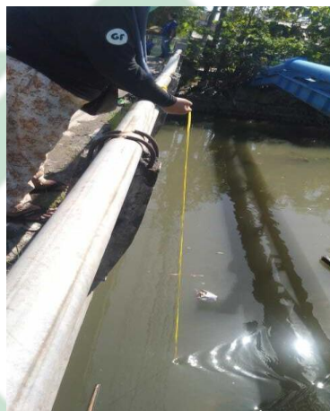
Gambar 4. 11 Mengukur Kedalaman Air Sungai
