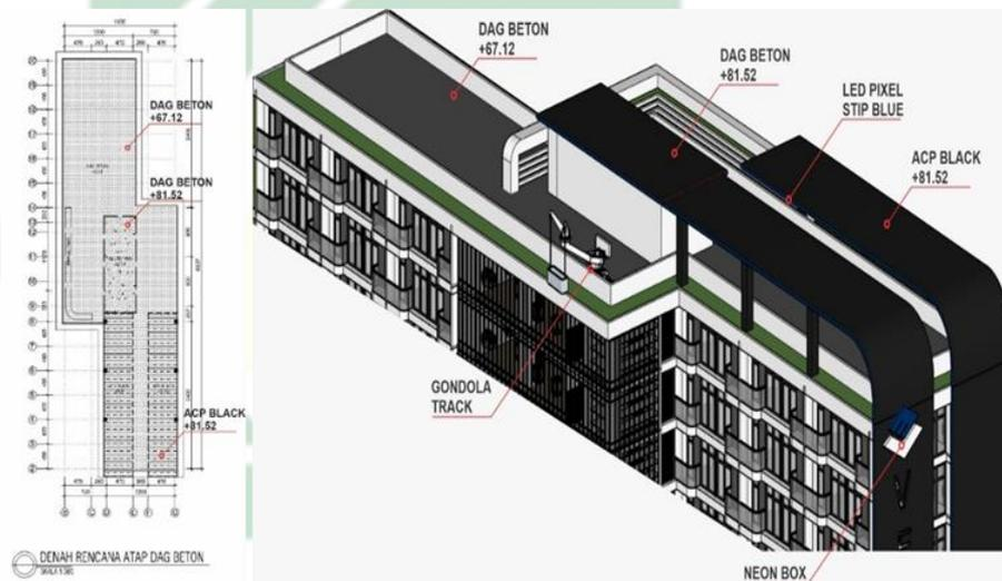
Gambar 4.11. Denah Rencana Atap dan Detail Atap
