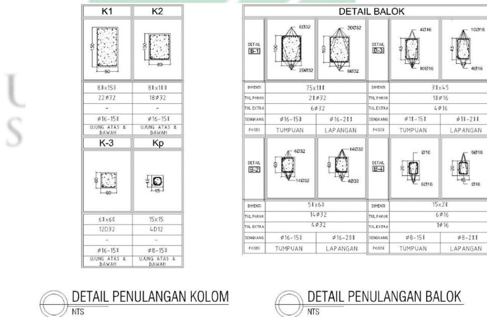
Gambar 4.10. Detail Penulangan Kolom dan Balok
