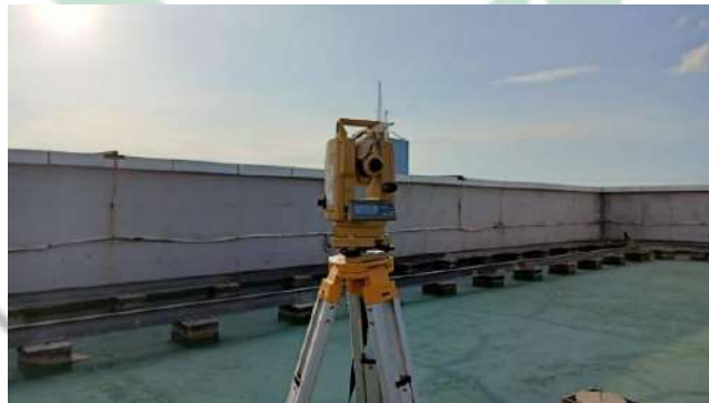
Gambar 3.5 Membidik Matahari menggunakan Teodolit
