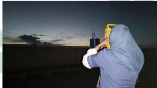
Gambar 4.14 Membidik arah Utara sejati untuk pengamatan benda langit (Bulan) menggunakan Teodolit
