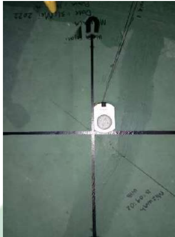
Gambar 3.7 Mengukur arah Utara sejati menggunakan Kompas analog Suunto KB-14
