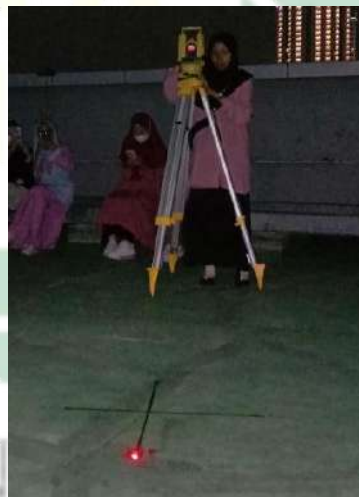
Gambar 4.12 Membidik arah Utara sejati untuk Rukyatul Hilal menggunakan Teodolit
