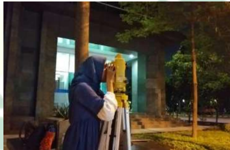
Gambar 4.5 Membidik Bulan untuk menentukan arah Utara sejati di medan magnet rendah menggunakan Teodolit
