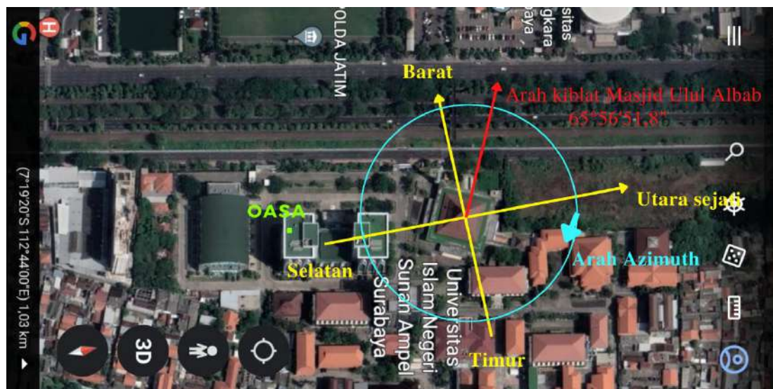
Gambar 4.16 Representasi dan estimasi arah Utara sejati di Gedung Twin Tower UINSA
