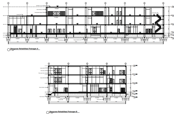
Gambar 4. 11 Potongan Bangunan Rehabilitasi
