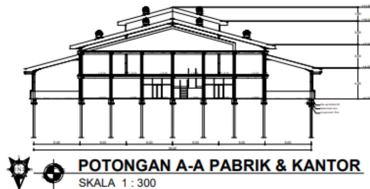
Gambar 4.8 Potongan A-A Bangunan Pabrik dan Kantor
