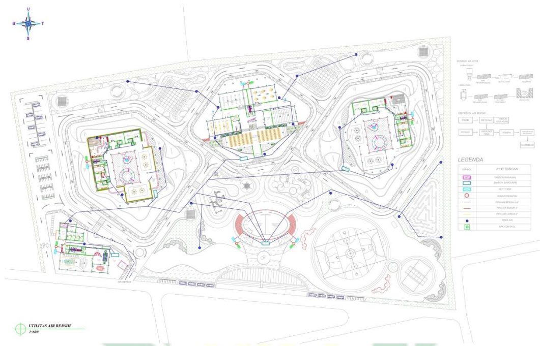
Gambar 4. 12 Utilitas Air Bersih
