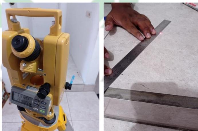
Gambar 4.10. Pengukuran arah kiblat menggunakan teodolit
