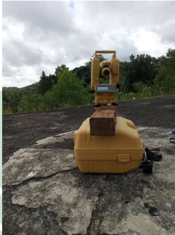
Gambar 3.2 Teropong Teodolite Ke Arah Utara Sejati
