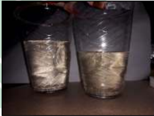
Gambar 21.7 Perbedaan Air Jublang (Kanan: Sebelum difilter, Kiri: Setelah difilter)
