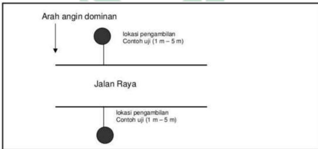
Gambar 3.3 Peta Penentuan Titik Sampling Pemantauan Kualitas Udara Roadside
