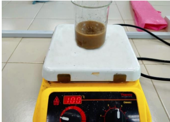
Gambar 4.4 Proses Pemanasan Bioplastik
