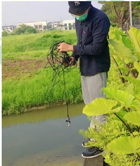
Gambar 4. 1 Pengukuran Kecepatan Arus Air dengan Current Meter
