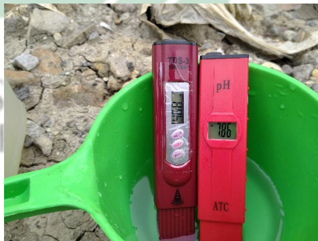
Gambar 4. 8 Pengukuran TDS menggunakan TDS Meter
