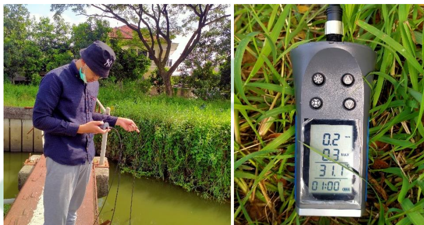
Gambar 4. 5 Pengukuran Suhu air menggunakan Thermistor Probe pada Alat Current meter .
