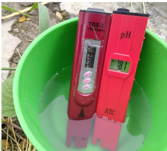
Gambar 4. 10 Pengukuran parameter lapangan pH menggunakan pH meter Digital.
