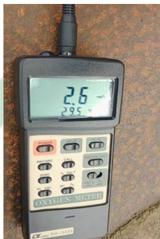
Gambar 4. 11 Pengukuran Oksigen Terlarut dengan DO Meter Digital
