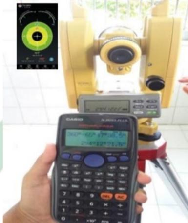
Gambar 3.13 Teodolit dengan Azimuth Kiblat  $294^{\circ} 12' 21.5''$
