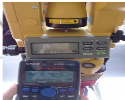
Gambar 3.19 Teodolit dengan Azimuth Kiblat  $294^{\circ} 13' 28.1''$
