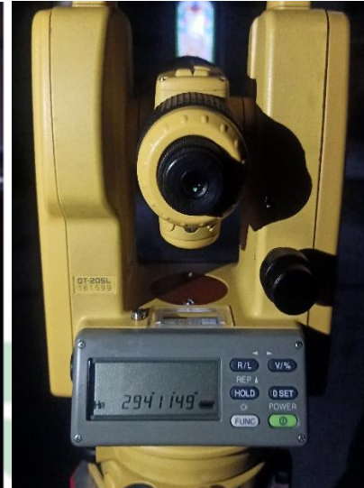
Gambar 4.6. Pembidikan Arah Kiblat pada tanggal 9 Agustus 2022 dengan titik acuannya adalah azimuth bintang Sirius
