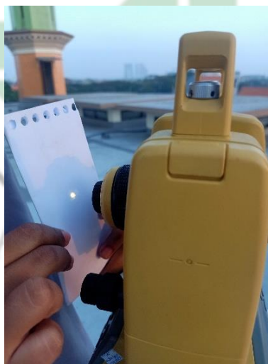
Gambar 4.17. Tanda bidikan Matahari menggunakan alat Theodolite
