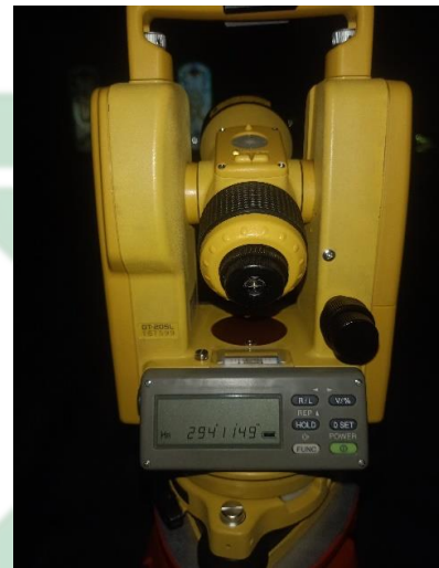
Gambar 4.14. Pembidikan Arah Kiblat pada tanggal 22/08/2022 dengan titik acuannya adalah azimuth bintang Sirius
