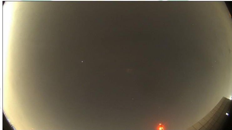
Gambar 44. Kondisi langit tergelap pada 17,06 MPSAS dari data dengan grafik mendekati ideal. Data diambil dengan kamera Allsky pada 5 Agustus 2022 pukul 04:30 WIB
