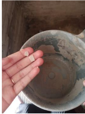
Gambar 5.2 Kerak Pada Alat Mandi Akibat Dari Air zat Kapur
