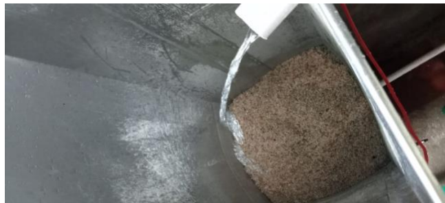
Gambar 5.8 Endapan Kapur Pada Filter
