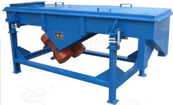
**Gambar 4.12** Mesin Pengayak Otomatis
