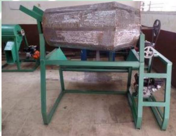
**Gambar 5.8** Mesin Pengayak Otomatis
