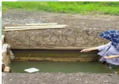
Gambar 4. 29 Pengukuran Arus Ketika Surut Terendah Sumber : Dokumentasi pribadi
