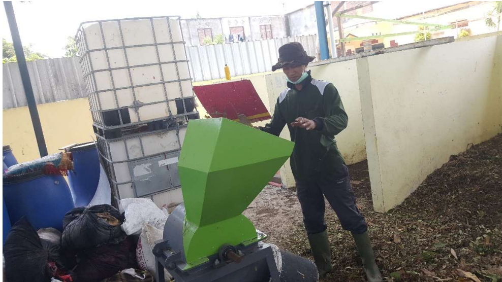
Gambar 3.3: Proses pencacahan sampah organik untuk pupuk padat
