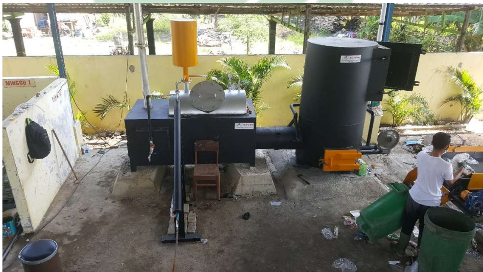
Gambar 3.2: Proses Pembakaran sampah plastik menjadi BBM
