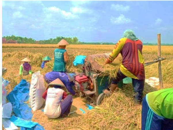
Gambar 4. 4 Proses panen dengan power thresher
