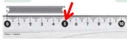
c) Perhatikan garis pada skala mistar yang bertepatan dengan ujung lain benda! Garis tersebut menunjukkan hasil pengukuran panjang benda.
