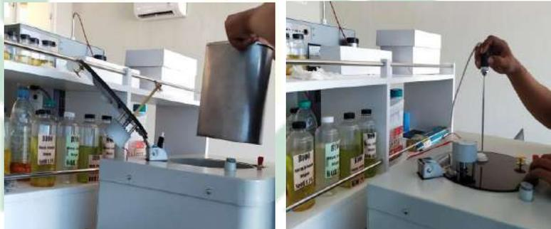
**Gambar 4. 21** Peletakan Ember Baja ke dalam Bomb Calorimeter
