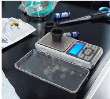
**Gambar 4. 17** Penimbangan Sampel Bioalkohol untuk Pengujian Nilai Kalor
