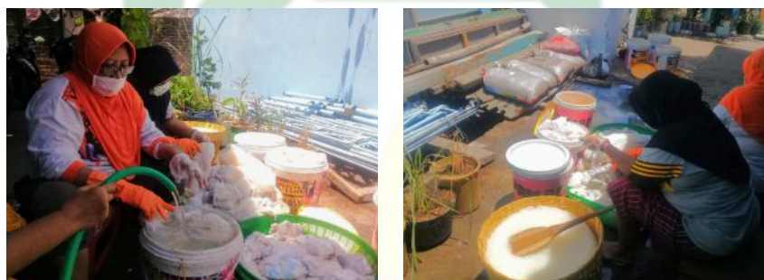
Gambar 4. 8 Proses Pembersihan dan Pemisahan Hidrogel pada Sampah Popok Sekali Pakai
