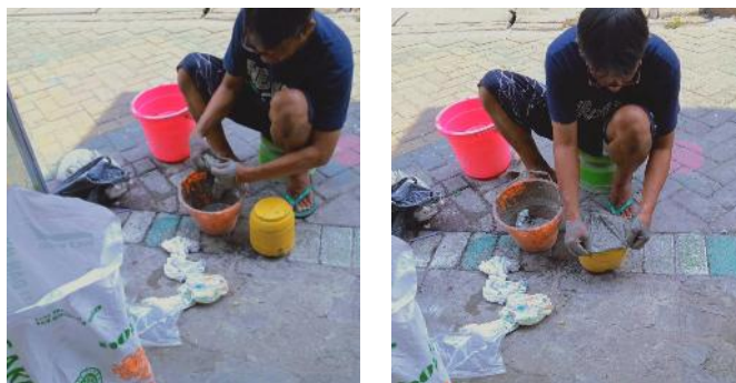
Gambar 4. 9 Proses Pembuatan Pot dari Sampah Popok Sekali Pakai
