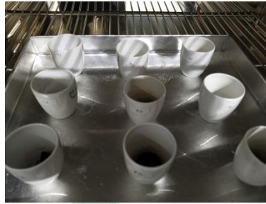
Gambar 3. 60 Proses Pengovenan Sampel Briket Sumber: Dokumentasi Pribadi (2023)
