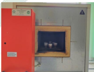
Gambar 3. 35 Proses Karbonisasi Bahan Baku Sumber: Dokumentasi Pribadi (2023)
