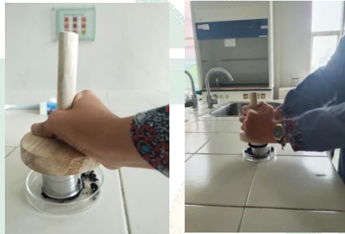
Gambar 3. 52 Proses Pembriketan Sumber: Dokumentasi Pribadi (2023)
