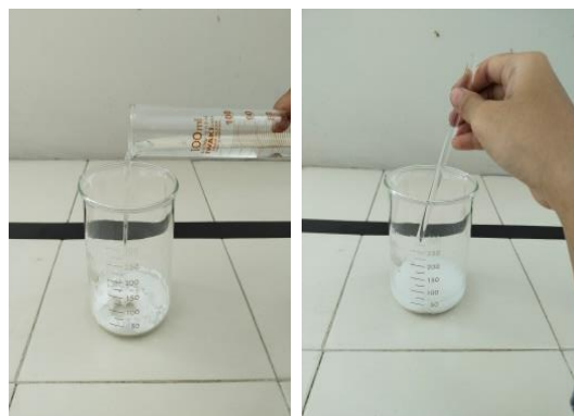
Gambar 3. 47 Proses Pelarutan Tepung Tapioka Sumber: Dokumentasi Pribadi (2023)
