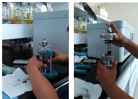
Gambar 3. 69 Pemasangan Cawan pada Tabung Bomb Sumber: Dokumentasi Pribadi (2023)
