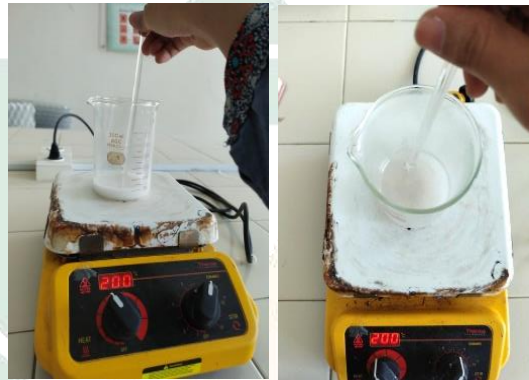
Gambar 3. 48 Proses Pemanasan Larutan Tepung Tapioka Sumber: Dokumentasi Pribadi (2023)
