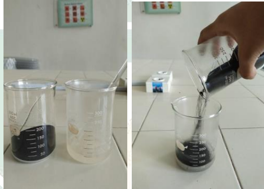
Gambar 3. 50 Proses Pencampuran Serbuk Arang dan Perekat Sumber: Dokumentasi Pribadi (2023)
