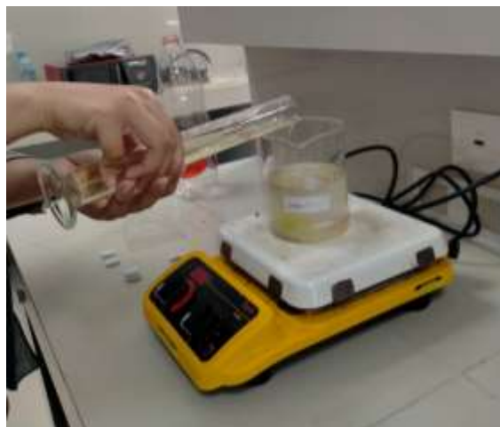
Gambar 4. 3. Penghilangan Bahan Organik pada Sampel Air (Sumber: Dokumentasi Pribadi, 2023)
