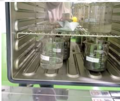
Gambar 4. 5. Pengeringan Sampel Sedimen (Sumber: Dokumentasi Pribadi, 2023)
