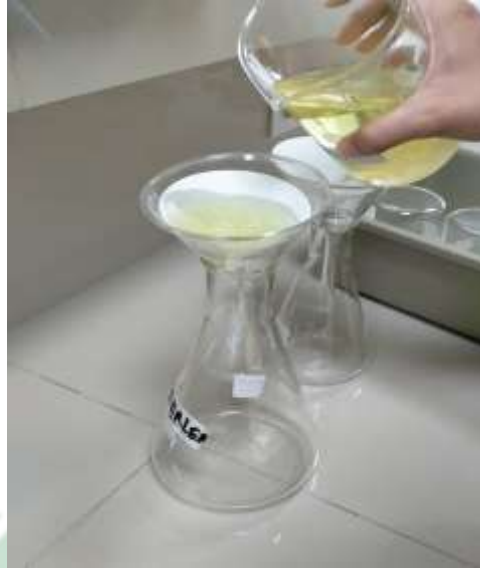
Gambar 4. 8. Pemisahan Densitas Sampel Sedimen (Sumber: Dokumentasi Pribadi, 2023)
