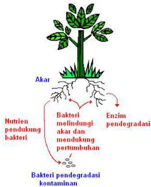
Gambar 2. 5 Skema Sistem Fitoremediasi
