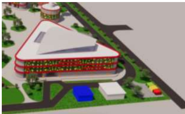
Gambar 4. 19 Letak Rumah Panel dan Genset
