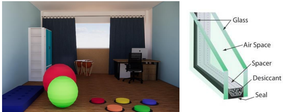
Gambar 4. 18. Ruang Terapi Orientasi Mobilitas (Kiri) dan Detail Jendela Peredam Kebisingan (Kanan)
