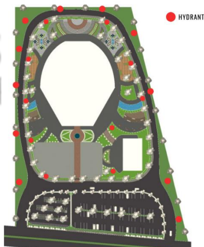
Gambar 4. 10 Utilitas kebakaran (Sumber :Ilustrasi Pribadi, 2023)
