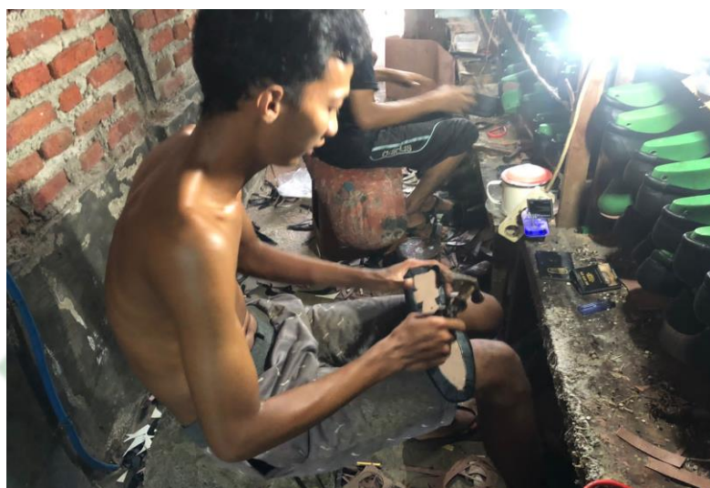
Gambar 4. 4 Proses Pemasangan Upper Pada Sepatu
