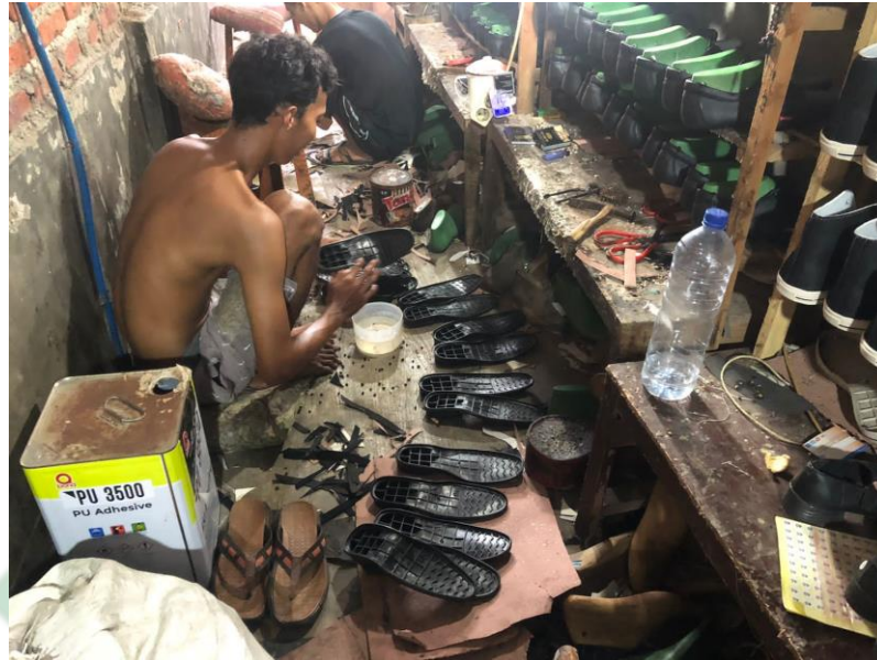
Gambar 4. 5 Proses Pemasangan Sol Pada Sepatu
