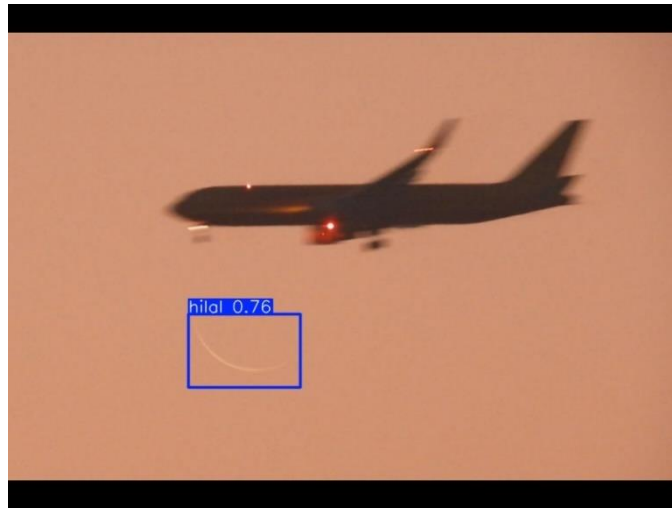
Gambar 17 Hasil Deteksi Hilal pada Citra Menggunakan Model YOLOV5
