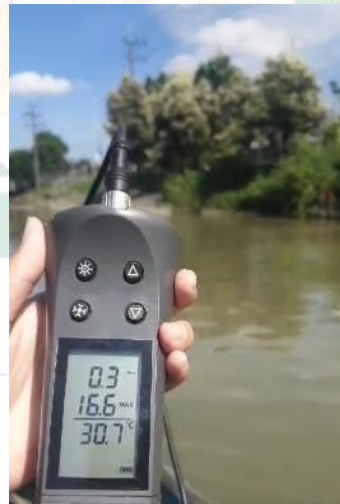
Gambar 4. 9 Pengukuran suhu menggunakan current meter
